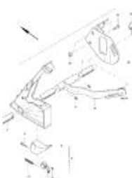
ETB-011070, вал клапана высевной коробки, переводной рычаг, паз для фиксатора
