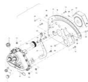
ETB-011072, редуктор типа Vario, части навешивания
